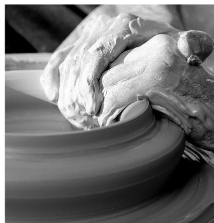
L'analyse et la compréhension des méthodes de tournage adaptées à ces formes, seront abordées avec des difficultés croissantes et des poids de terre allant de 500gr à 3 kg.
